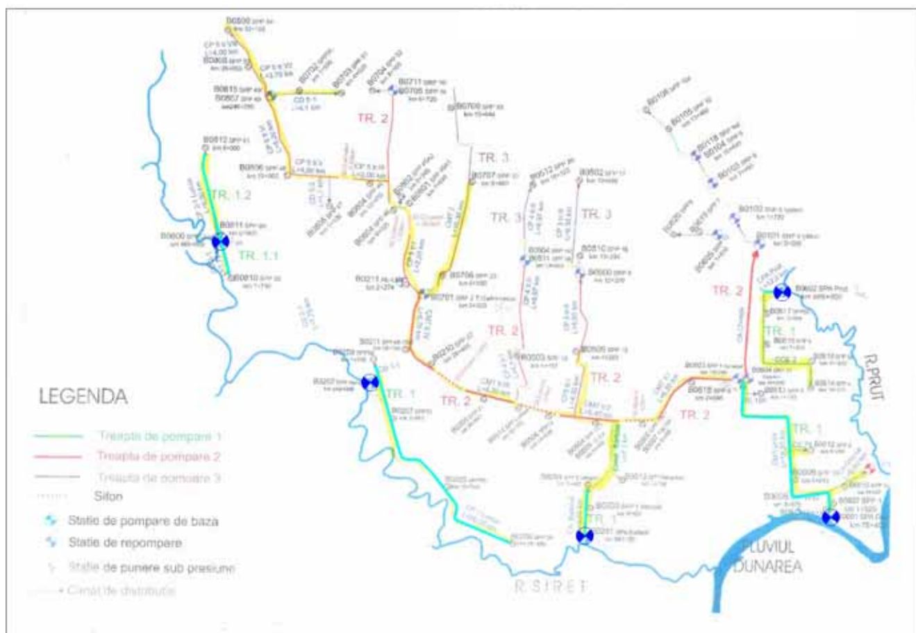
Figura 3. Schema sistemului de irigații Câmpia Covurlui
